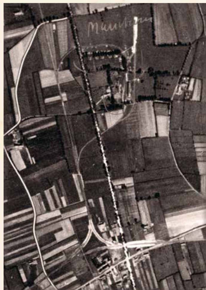
Luchtfoto met tracé van het smalspoornetwerk uit WO1 ter hoogte van de Westkerksestraat in Westkerke.
